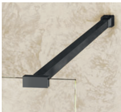
■ MI TWF NPE - vzpěra v černé barvě Černý elox Standardní délku vzpěry 1200 mm lze zkrátit
